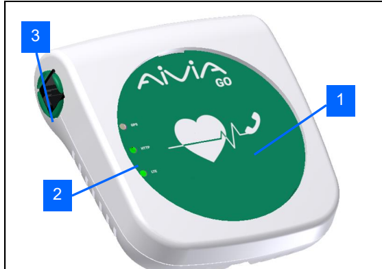
1- Botón de llamada. 2- Indicadores de estado. 3- Conector RJ12 del sensor de DEA / Mantenimiento.
